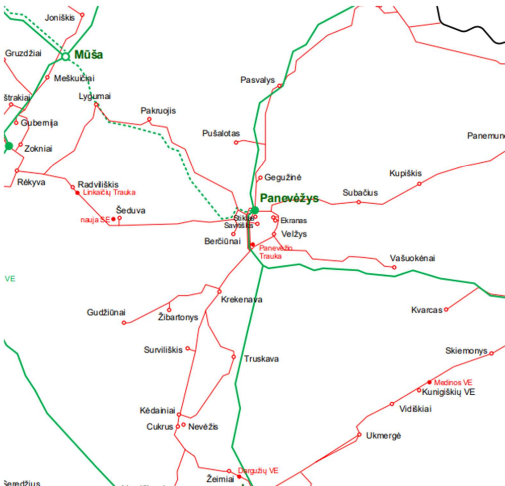
10.1. Pav. Lietuvos elektros energetikos sistemos 400-110 kV perdavimo tinklų schemos ištrauka
