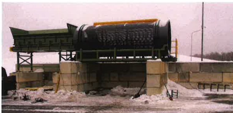
25 pav. Elektrinis būgninis sietas komposto sijojimui
