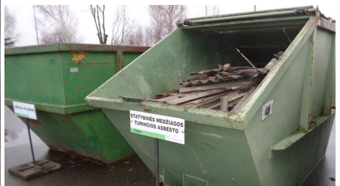
11 pav. Statybinių medžiagų, turinčių asbesto atliekos
