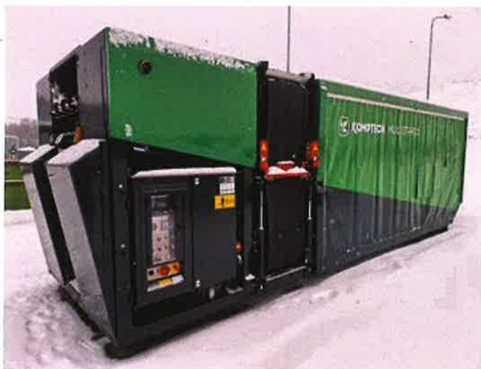
35 pav. Įsigytas žvaigždinis sijotuvus su oriniu separatoriumi
