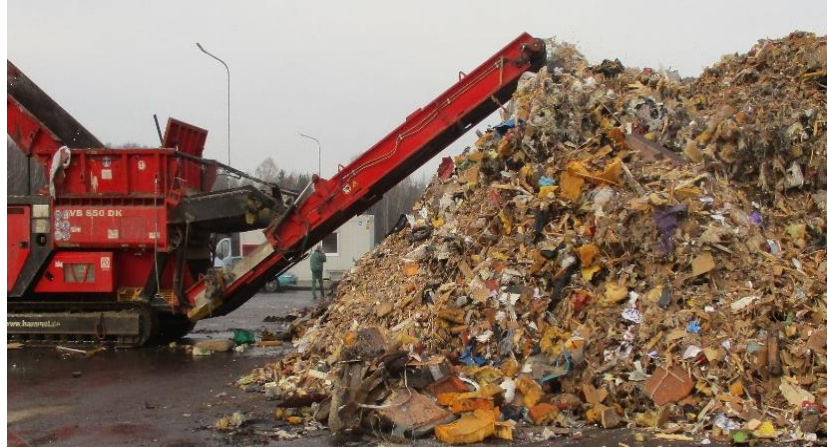
37 pav. Didelių gabaritų atliekų smulkinimas paruošiant atliekas naudoti energijos gamyboje
