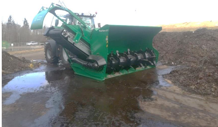
42 pav. UAB „RB Baltic“ pristatytas mobilus komposto vartytuvas
