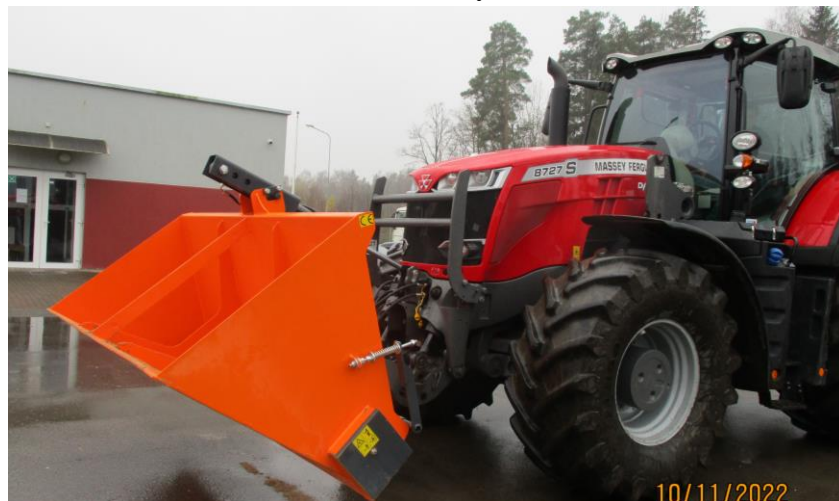
31 pav. Ant traktoriaus pakabinamas smėlio- druskos barstytuvas
